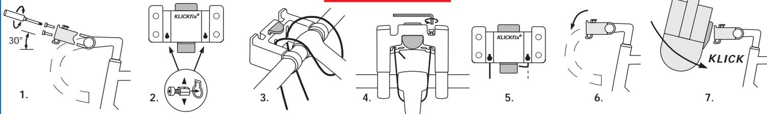
**1. Gehäuse montieren** Beide Kunststoffbügel auf den Lenker aufrasten. Gehäuse auf die Kunststoffbügel schieben. Schrauben in Gehäusevorderseite einstecken und leicht anspannen. Der Adapter muß schräg nach oben ausgerichtet sein.
